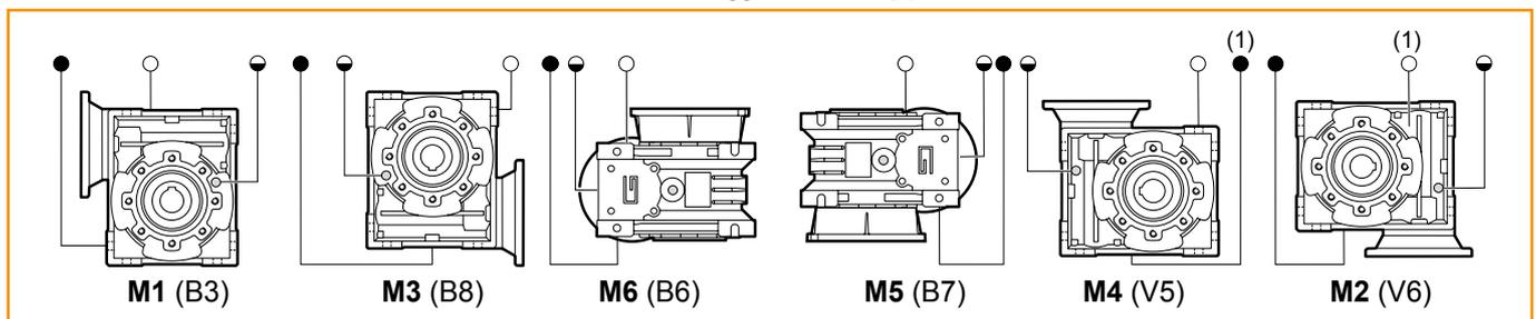
(1): Tappo in posizione posteriore / *Plug in backside position*
